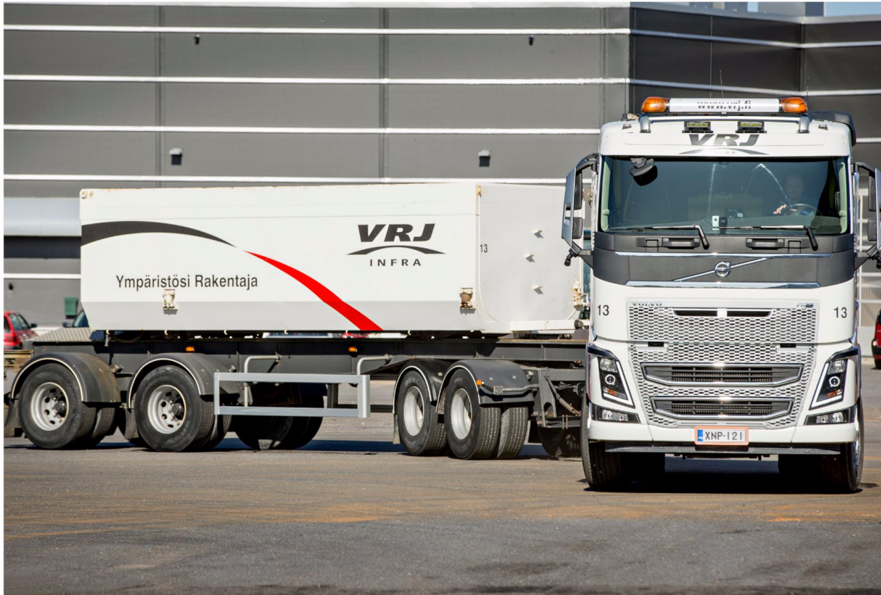
Rekan kääntymisvaroitin on järjestelmä, jossa kevyen liikenteen kulkijoita varoitetaan äänimerkillä sekä vilkkuvilla äärivaloilla. Juuri liikenteen aloittaneeseen autoon on asennettu kamerat nupin molemmille puolille ja tuulilasien sisäpuolelle. Kamerrat kuvaavat tapahtumia rekan nupin molemmilta puolilta sekä edestä tuulilasien sisäpuolelta.
