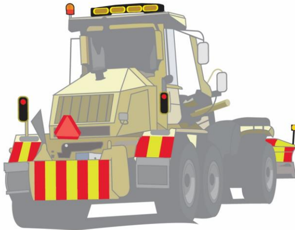
Kuva 10. Tiehöylän havaittavuutta parantavat merkinnät.
