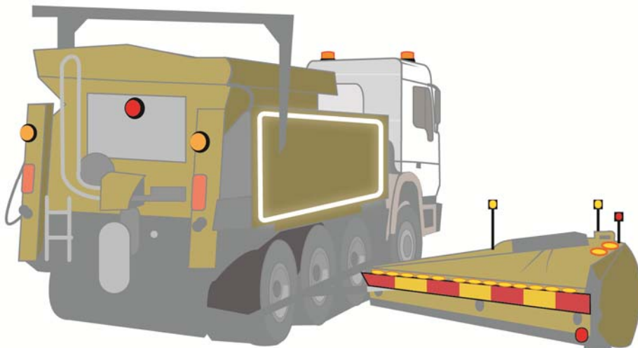
Kuva 3. Sivuauran havaittavuutta parantavat laitteet
